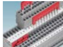
Standart köprüleme sistemiyle 50'ye varan adette klemens uygulama gerektiği takdirde birbirlerine bağlanabilir
